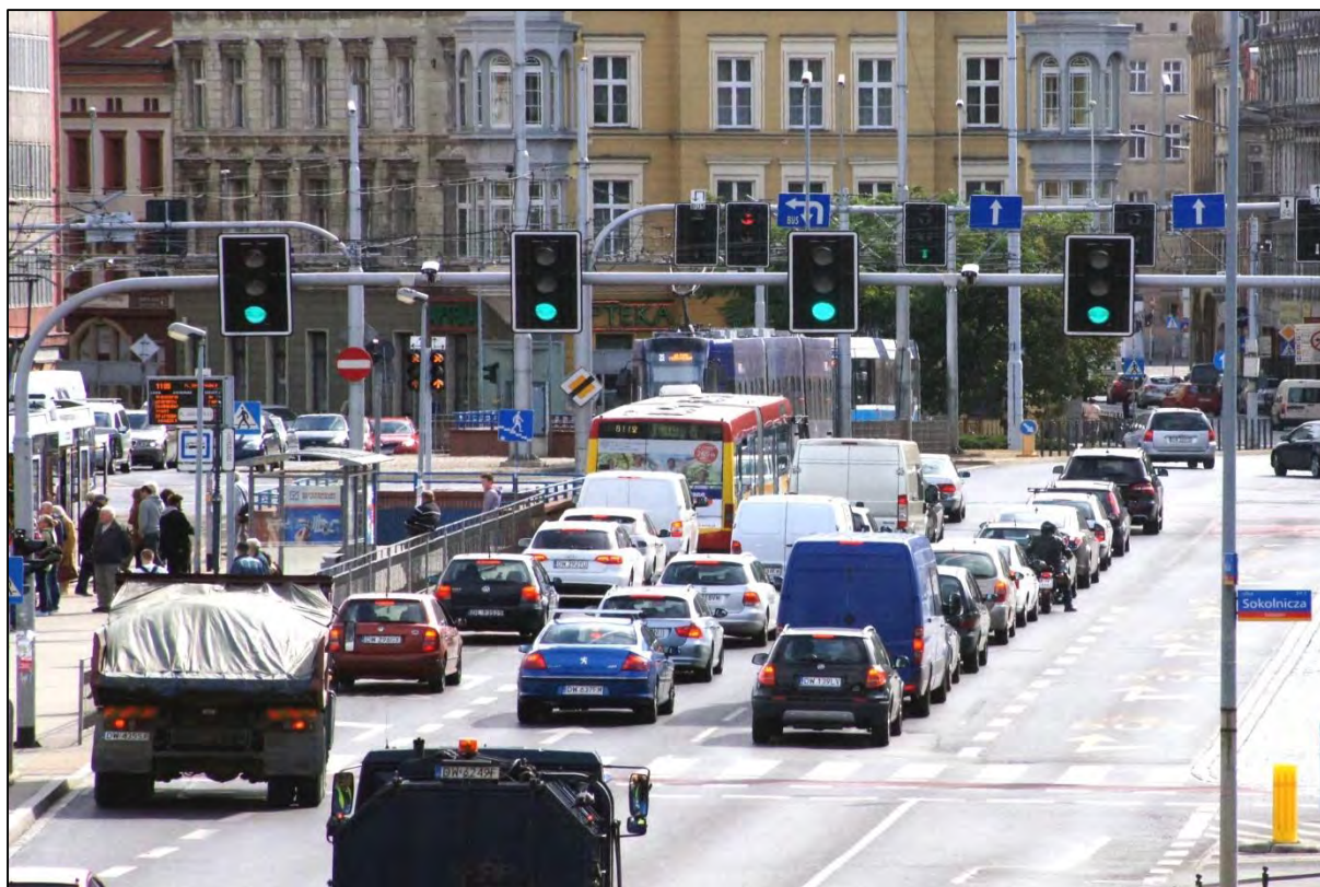
Rys. 3.3.4. Przykład dobudowanego przejścia naziemnego, które wraz z dotychczasowym przejściem podziemnym umożliwia dojście na przystanek położony w pasie dzielącym jezdnię drogi. System sterowania zapewnia płynny przejazd przez obie sygnalizacje świetlne (źródło własne).
